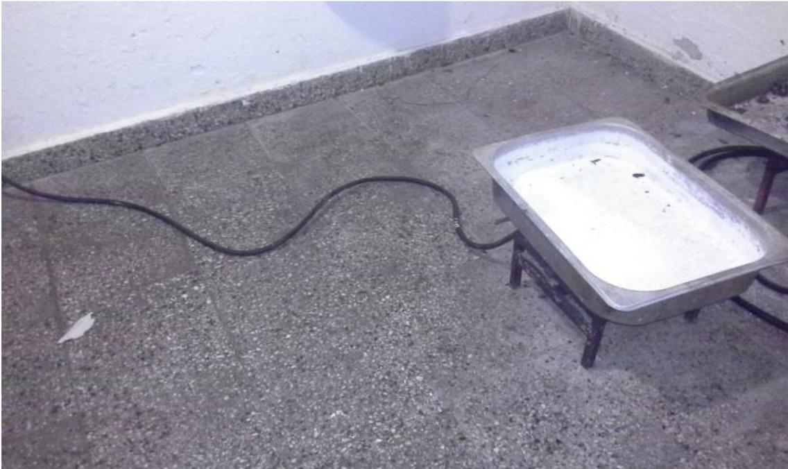
Imagen 5: Dispositivo a gas utilizado para controlar la temperatura y humedad del secadero manualmente.
